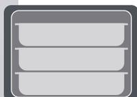
**Stapelweise bestückbar.** Für maximale Kapazität lassen sich im B.PROTHERM 320 ECO-C die GN-Behälter in verschiedenen Höhen und Größen **neben- und übereinanderstapeln.**
