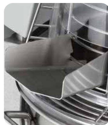
Zugriffsschutz kann für die Reinigung abgenommen und im Geschirrspüler gereinigt werden.
